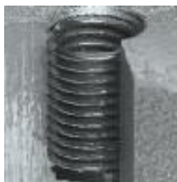
Componente in fusione d'alluminio. Tutte le filettature hanno una profondità di filettatura limitata.
