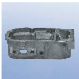
Nelle Fusioni di alluminio di scatole cambio. Difficoltà di rottura del trascinatori dovuta alle sue piccole dimensioni.
