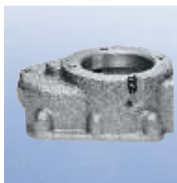
Fusione in alluminio scatola cambio. Rimozione del trascinatori difficile da effettuare.
